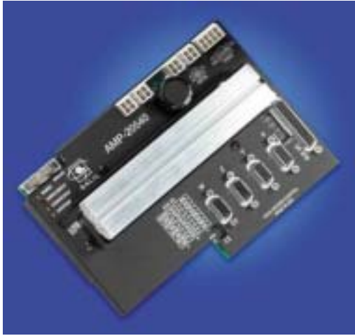
图 3. AMP-20540 四轴无刷伺服放大器（每轴 500W）
